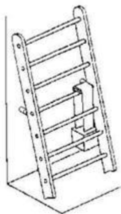
Hình 6 – Sơ đồ đặt hoặc treo tải trọng kiểm tra
